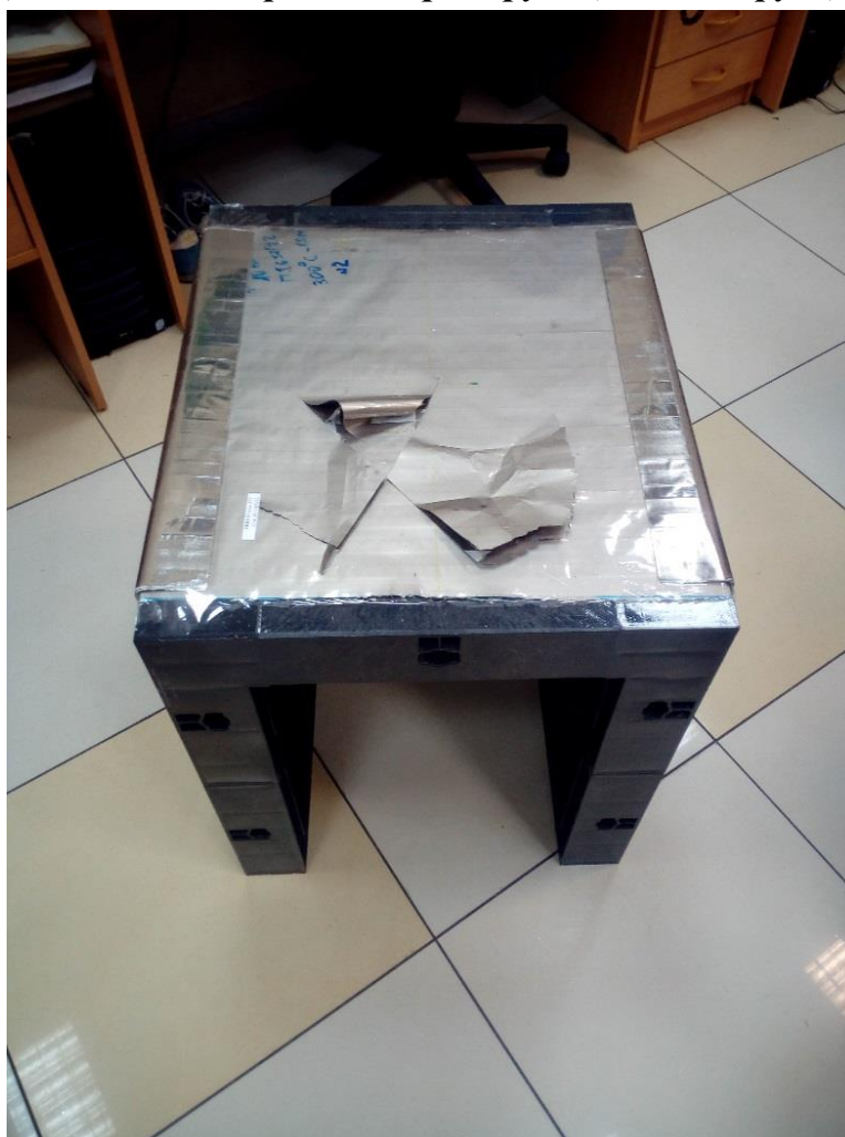
Поврежденная П-образная экранирующая конструкция
