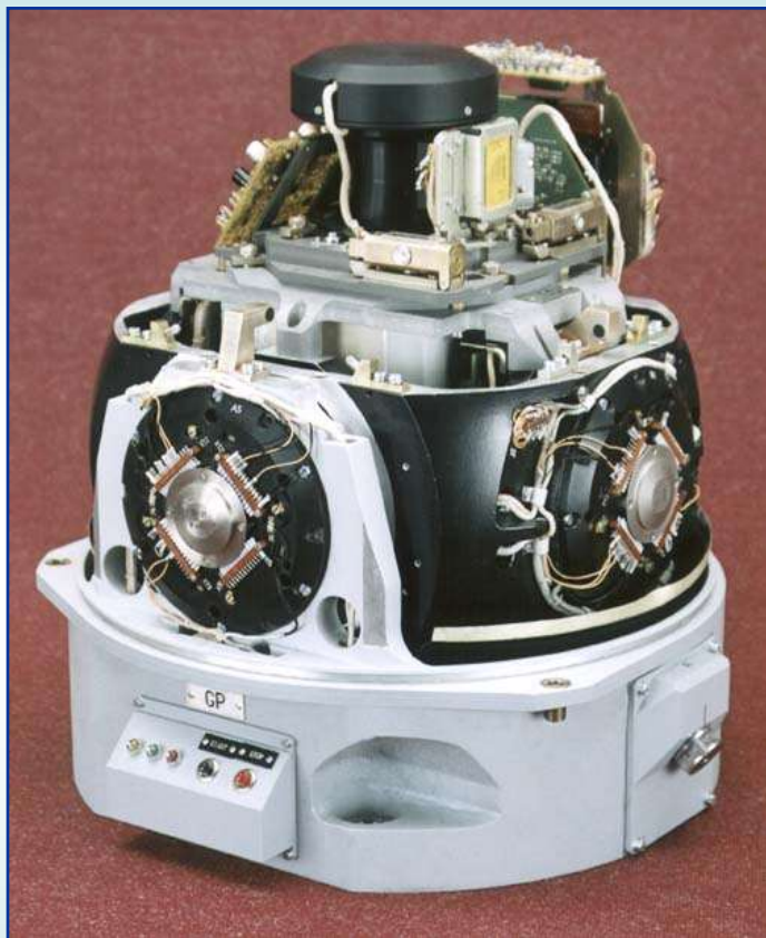
Мобильный (аэроморской) гравиметр «Чекан-АМ» СКП 0,72 мГал
