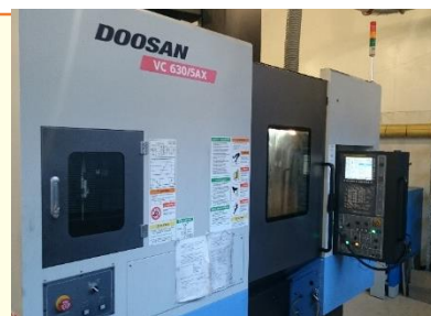
5-ти координатные обрабатывающие центры Doosan, Ibarma, Hermle (зона обработки до 1400 мм), ст. защиты IP 64
