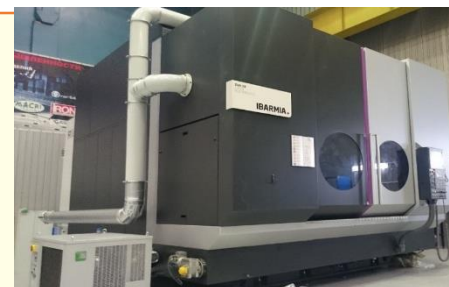
5-ти координатные обрабатывающие центры Doosan, Ibarma, Hermle (зона обработки до 1400 мм), ст. защиты IP 64
