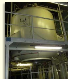
Печи ВТО 2700 С \varnothing 1600x2000 мм
