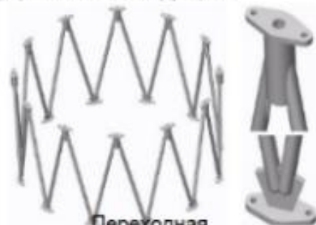
Переходная ферменная конструкция
