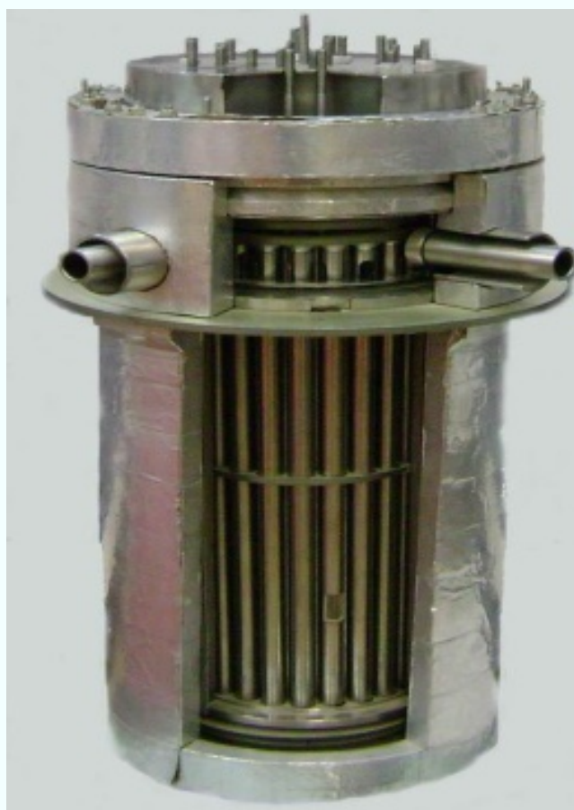
Теплообменное оборудование с титановыми трубами
