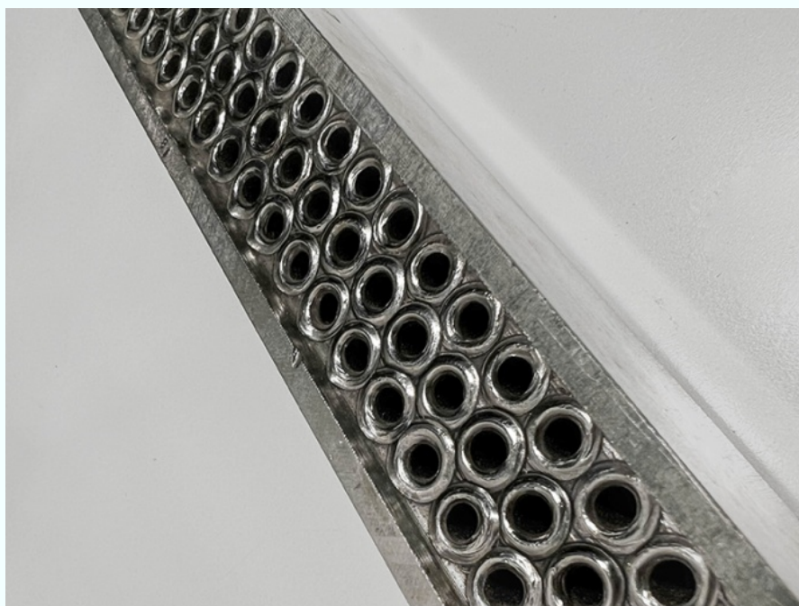
Образец соединения «труба–трубная решетка», выполненного ЭЛС для кассетного парогенератора
